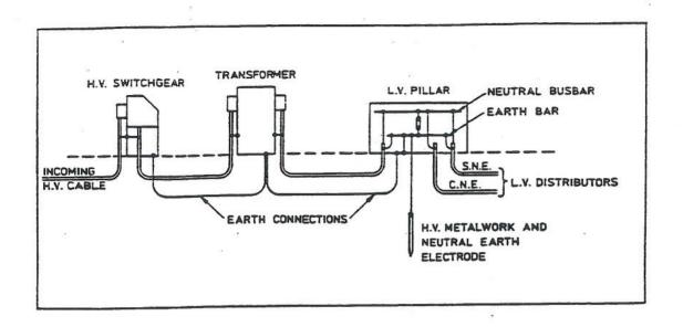
FIGURE 3: GROUND MOUNTED SUBSTATION OVERALL EARTH RESISTANCE ONE OHM OR LESS
